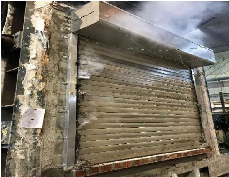
DIAMOND BL XTREME FIRE. RESULTADO TEST FIRE TRAS 84 MINUTOS
